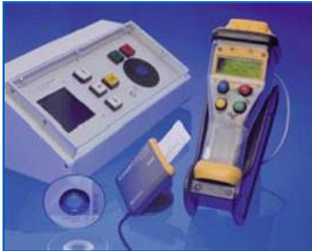
Mobiles Handgerät: Datenregistrierung im Terminal, Übertragung per Funk, DFÜ, Infrarot, oder über eine Dockingstation zum Zentralcomputer.
