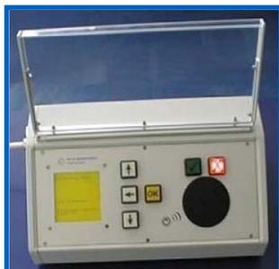
Das Bediengerät dient zur stationären Erfassung von Transpondern. Es ist mit einem Grafikdisplay, vier Tasten und zwei Zustandsanzeigen ausgestattet. Durch den modularen, inneren Aufbau können unterschiedliche Transponder-Reader integriert werden. Hierdurch kann eine umfangreiche Palette verschiedener Transponder gelesen werden.
